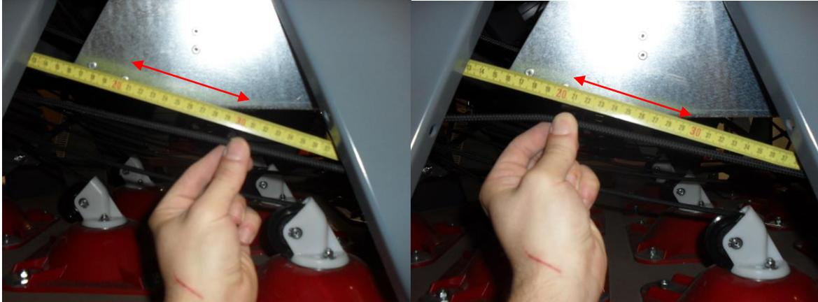
Si un ajustement est nécessaire, il vous faudra desserrer les 2 écrous ci dessous et déplacer le "switch" rouge.
